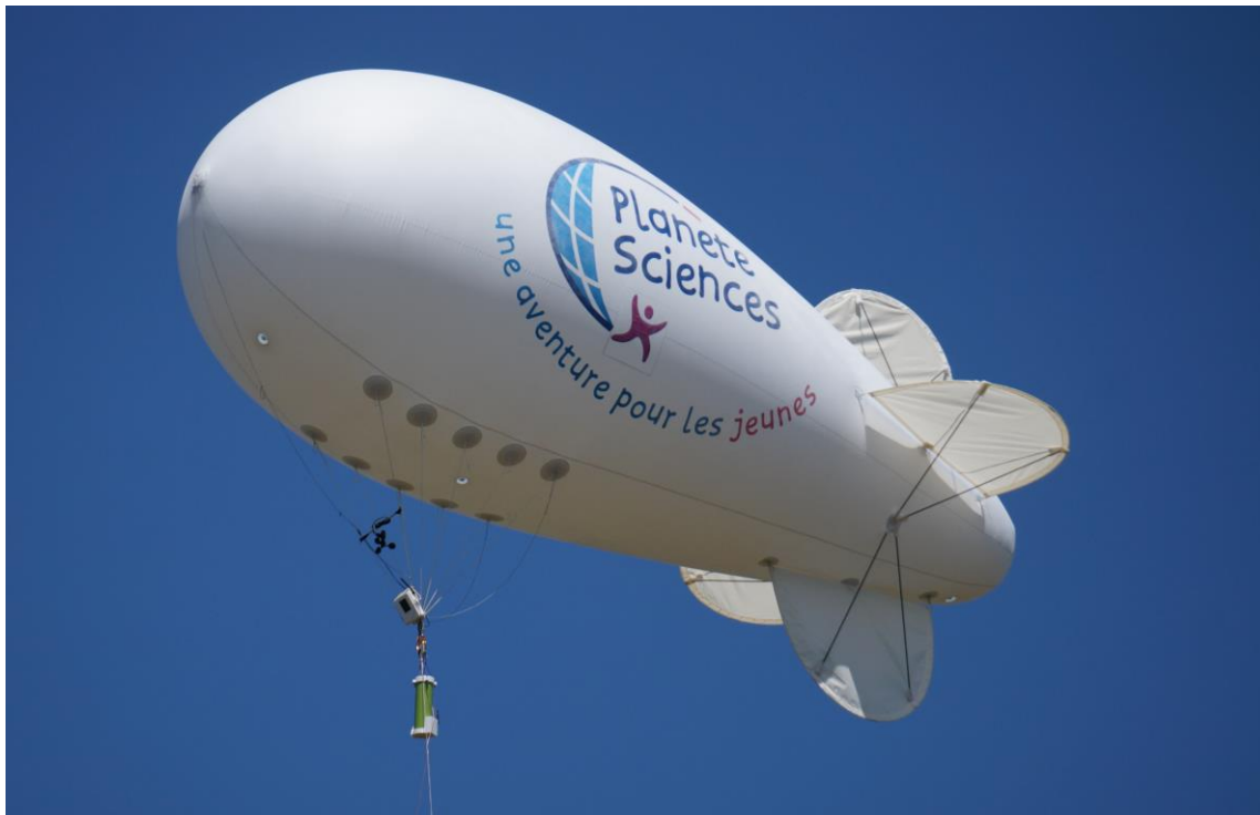
Illustration du largueur CanSat installé prêt à larguer un CanSat depuis 150 mètre d'altitude
